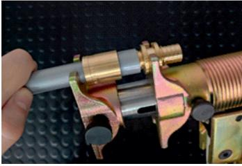
5. Натянуть кольцо на трубу с помощью запрессовочного инструмента (гидравлический, аккумуляторный или ручной пресс). Фитинги должны фиксироваться за фланец, непосредственно прилегающий к штуцеру, на который натягивается кольцо. Нельзя натягивать одновременно два кольца.
