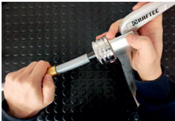
3. Выполнить раскалибровку трубы с помощью ручного или аккумуляторного расширителя:
