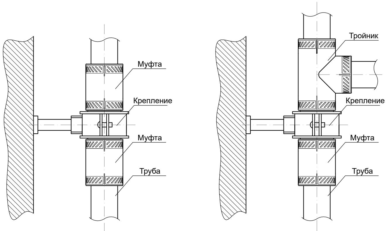
Примеры прокладки стоек системы горячего водоснабжения в зависимости от вида труб
