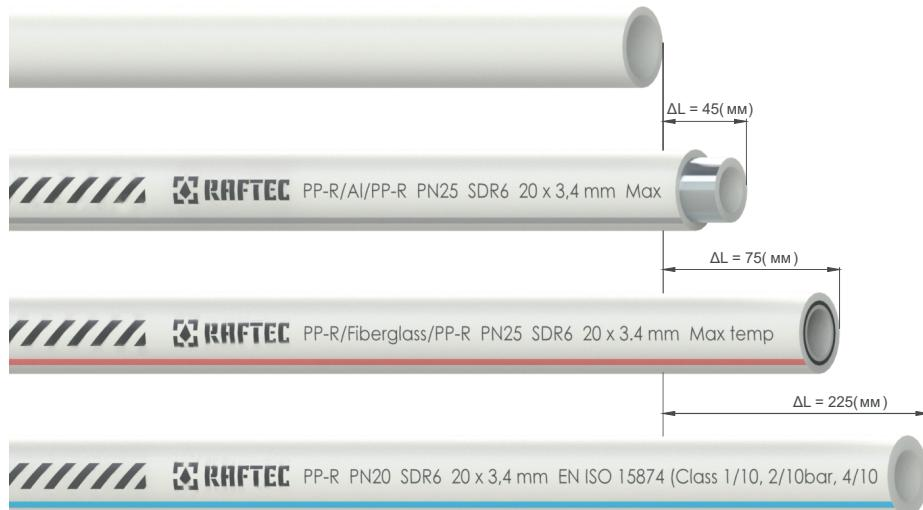
**Сравнение теплового удлинения однородных и комбинированных труб PN20, AI, Fiberglass PPR**
